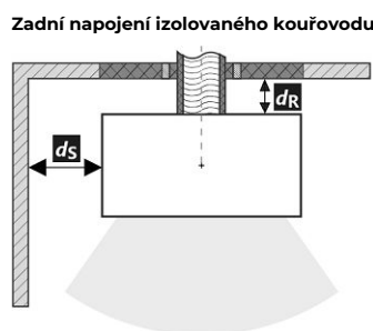
Prostup kouřovodu stěnou z hořlavé hmoty ČSN 06 1008
